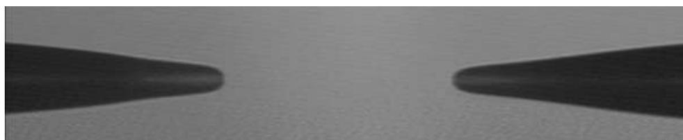
Рис. 3. Тепловой снимок перетяжки при изготовлении в соответствии с Вариантом № 2
