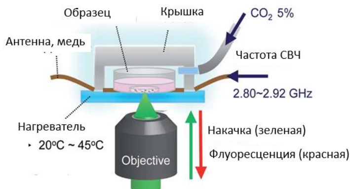
Рис. 7. Доставка зондирующего СВЧ-излучения в зону контроля температуры (адаптировано из [1])
