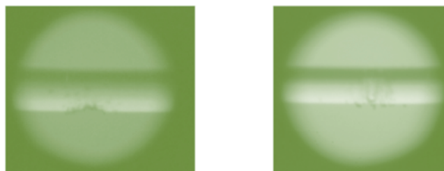
Рис. 2. Фотографии участка ОВ с нанесенным дефектом оболочки
